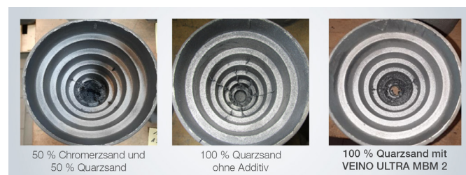
Abbildung 2: Große Stufenkegel, GJL. Gießtemperatur 1410°C. Wasserschichte, ca 300 µm Schichtstärke
