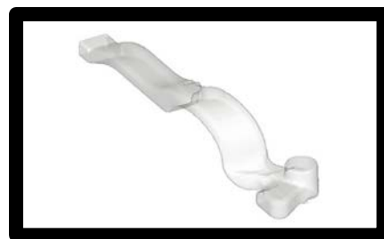
シーケンス #3 中子硬化完了ー4秒以内
