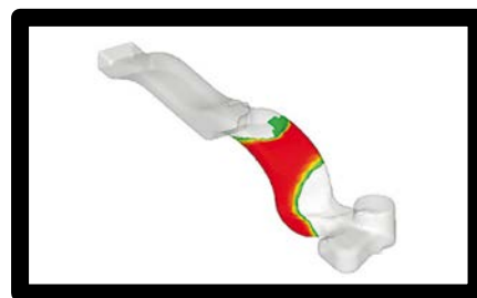
シーケンス #3 10秒以上のガッシング後なお未硬化部分が残る
