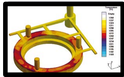
シーケンス#3 注湯完了。鑄型に溶湯充満後かなり温度が低下した状態。
